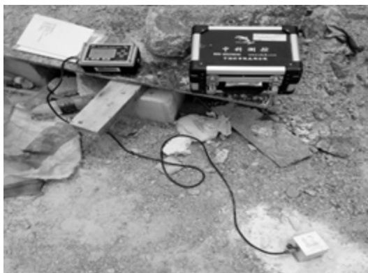
图 3 现场测振仪 Fig. 3 Field vibrometer
