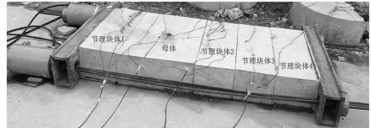
图2 多个水泥砂浆试样组成的组合模型试验
