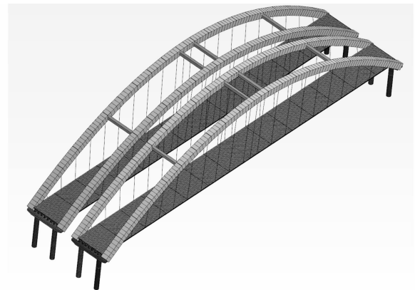
图 6 全桥倒塌有限元模型
