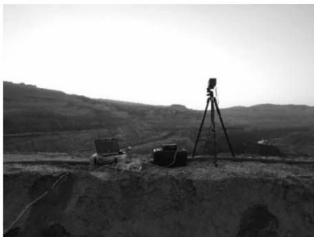
图6 IDT Y7-S2 高速摄像系统
