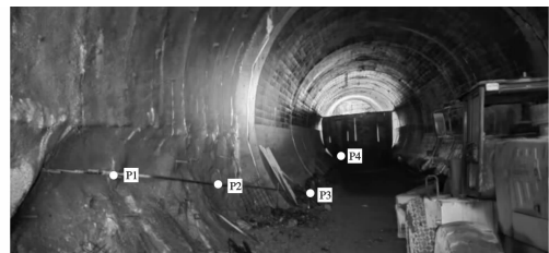
图 8 空气超压测点现场位置示意图
