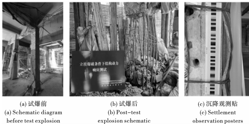
图 4 立柱试爆与沉降监测
