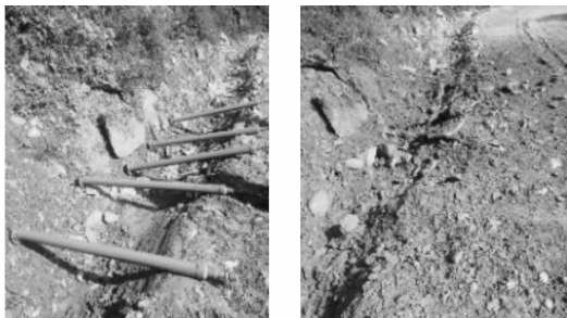
图5 0.25 MPa水压条件下爆破前后情况
