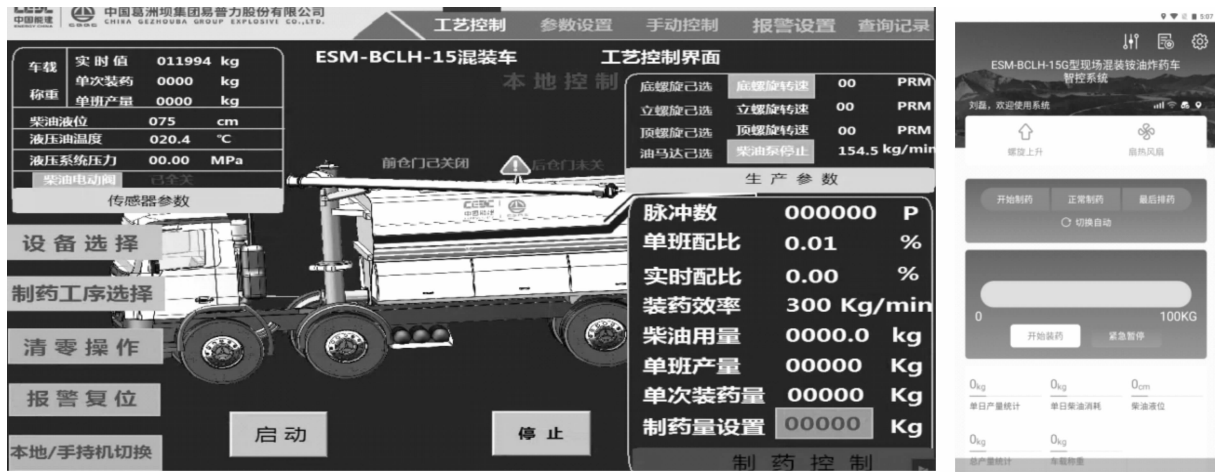
图4 电控系统及智控系统操作界面
