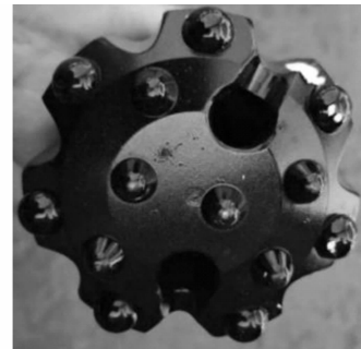
图 5 锥形钮扣钻头 Fig. 5 Tapered Button Drill
