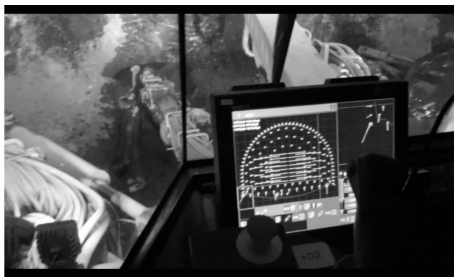
图 3 现场作业的电脑凿岩台车
