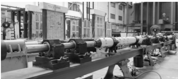
图 5 SHPB 试验装置
