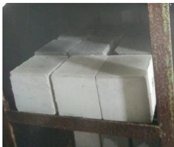
(d) 试块养护 28 d (d) Test block curing 28 days
