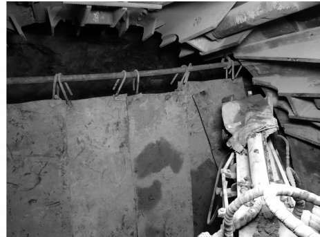
图 4 盾构机前端皮带防护示意图
