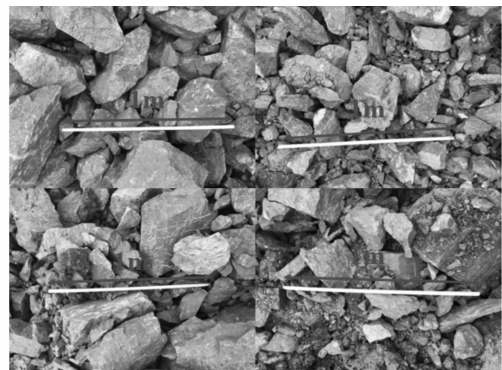
图3 爆破试验典型块度分布图
