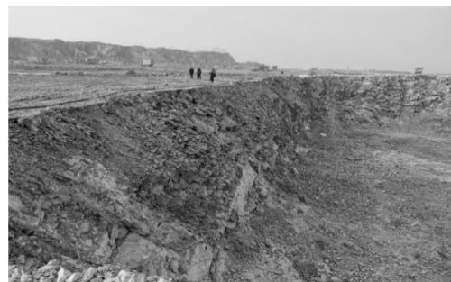
图 1 爆破试验前典型临空面
