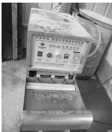
图5 KPS-60型水袋自动封装机 Fig. 5 KPS-60 water bag automatic packaging machine
