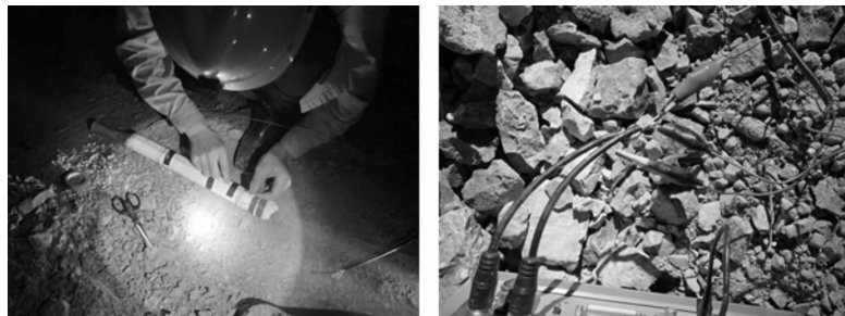
图 2 现场爆速测试
