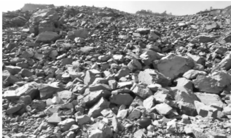
图 11 优化爆破参数爆破的爆堆情况 Fig. 11 Case of blasting pile with optimized blasting parameters
