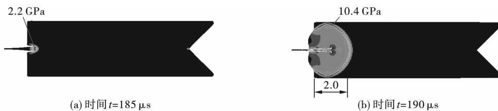
图 5 炸药间隔距离 50 cm 时被发乳化炸药压力云图(单位:cm)
