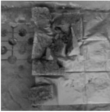
图 2 4 g 药量下素混凝土爆破效果
