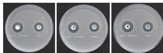
图4 3种木质素磺酸盐分散咯菌腈样品对金黄色葡萄球菌的抑菌环测试。
