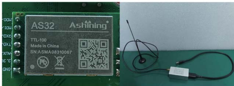
图 6 电脑端 LoRa 接收模块及封装后效果
