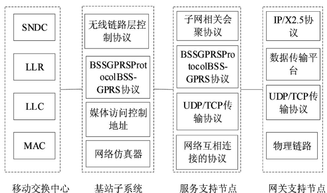
图4 GPRS无线通信网络协议栈结构
