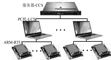
图 2 SCADA 模拟系统
