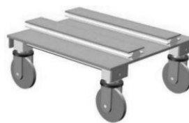
图 7 物流轨道车轻量化版三维模型
