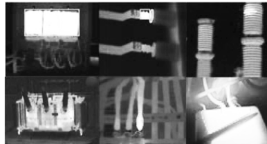
图 2 过热区域在电力变压器红外图像中的 SVG 标定
