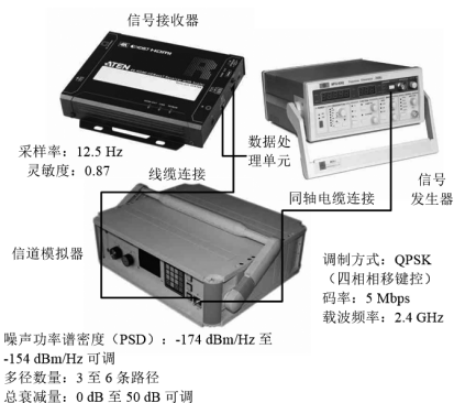
图 1 信号发生器、信道模拟器、接收器的连接方式与参数配置
