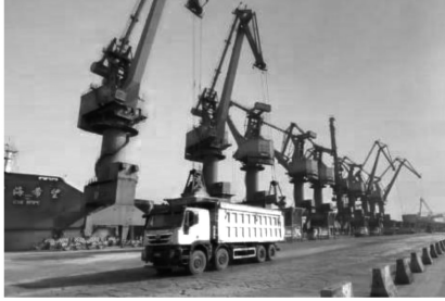
图1 散货港口抓斗门机卸船和接卸车辆
