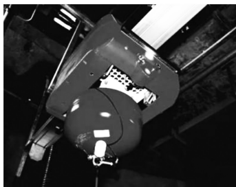
图 2 挂轨式智能灭火机器人喷头实物图
