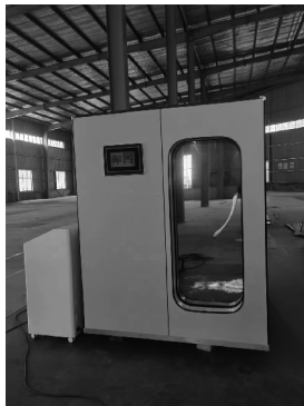
图1 微压舱实物照片
