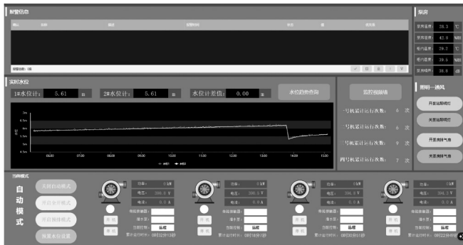
图6 泵站远程监视操作界面
