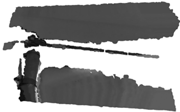
图 3 半径滤波后的点云数据
