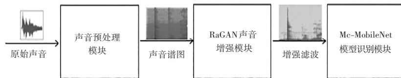
图 1 基于 RaGAN 和 Mc-MobileNet 干扰背景下煤机故障声音识别算法技术路线
