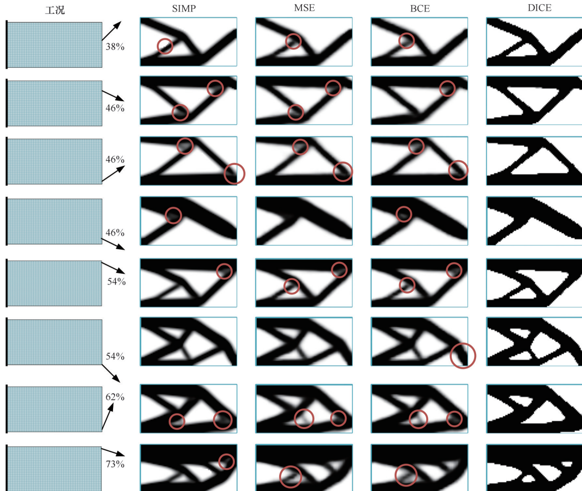
图9 SIMP和三种损失函数的拓扑优化结果对比
