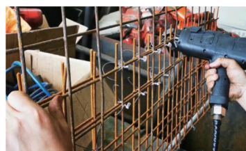
图26 锚网绑扎实验测试效果图
