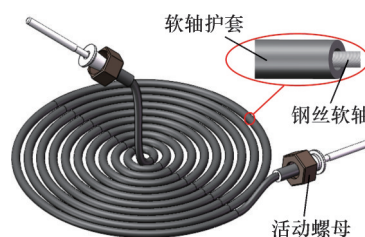
图6 软轴传动机构结构示意图
