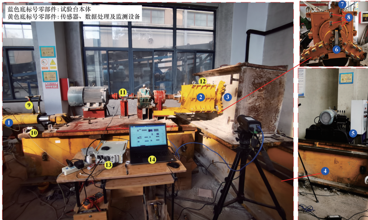
1. 推进装置 2. 全断面截割装置 3. 岩样 4. 岩样推移装置 5. 液压泵站及控制装置 6. 中心鱼尾刀O0 7. 边缘切刀A0 8. 刮刀A1~A5 9. 油压传感器 10. 拉线式位移传感器 11. 转速扭矩传感器 12. 振动传感器 13. 信号采集仪 14. 计算机
