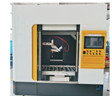
(a)3T2R构型高灵巧性机器人
