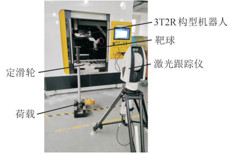
图4 刚度辨识实验 [14]
