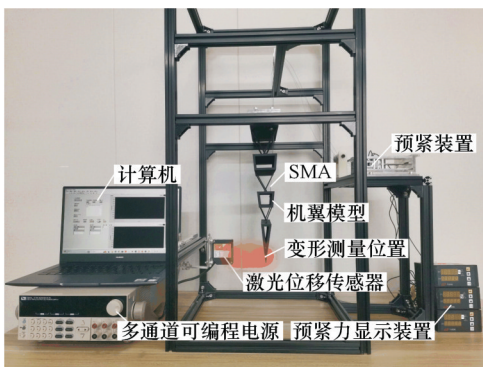
图 2 变弯度机翼变形控制实验装置
