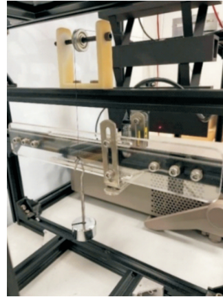
图 13 变弯度机翼施加 100 g 载荷
