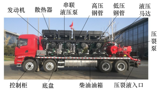
图1 318E全液压压裂车
