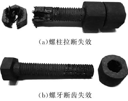
图 1 螺栓失效形式 Fig.1 Bolt failure form
