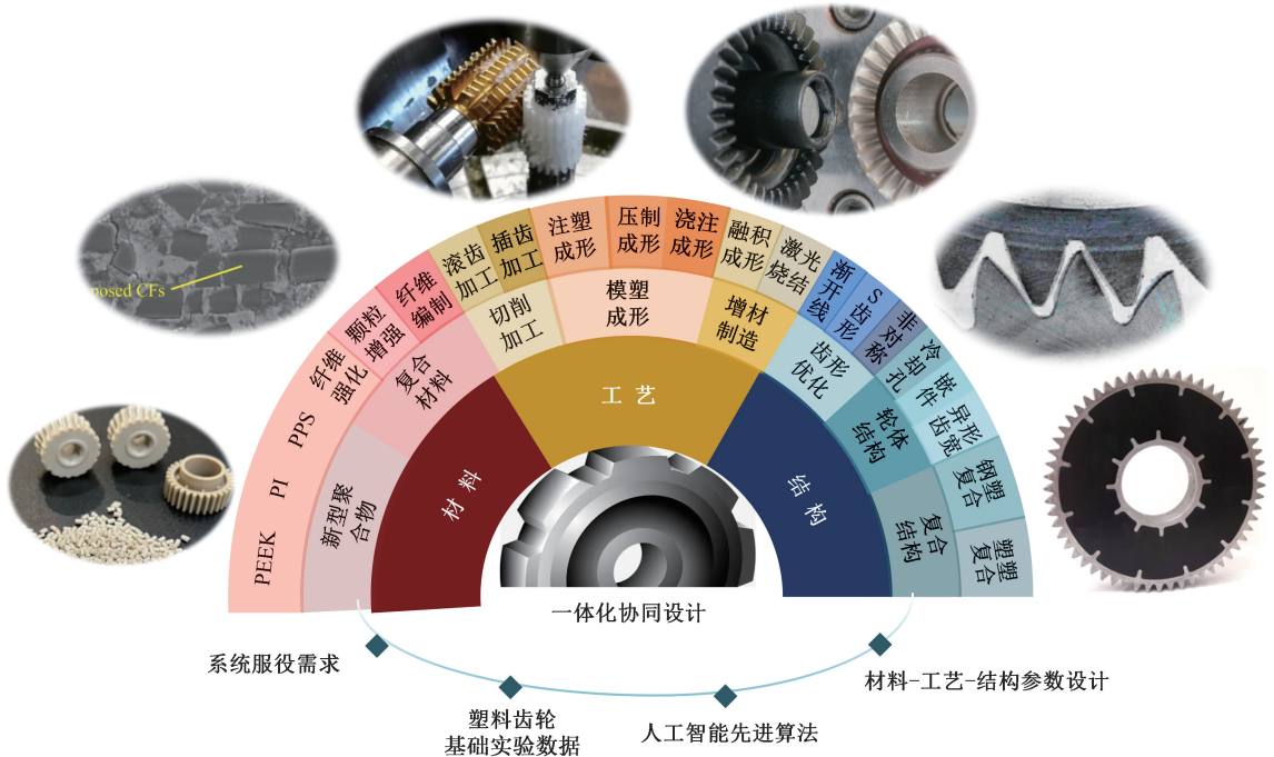
图 10 塑料齿轮材料-工艺-结构协同设计
