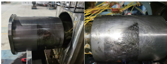
图15 优化销轴加载 11 250 次后的磨损情况
