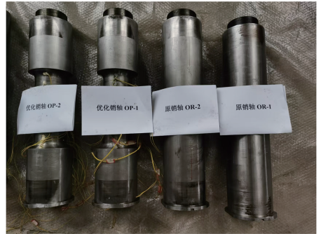
图16 优化销轴与原实心销轴的损伤对比
