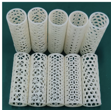
图 16 仿生轻质管结构成形效果
