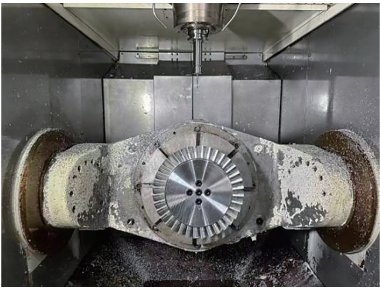
图 23 摇篮式五轴加工中心
