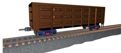
图 6 单节列车动力学模型
