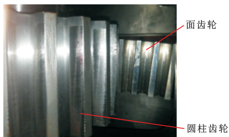
图 17 实验用面齿轮副
