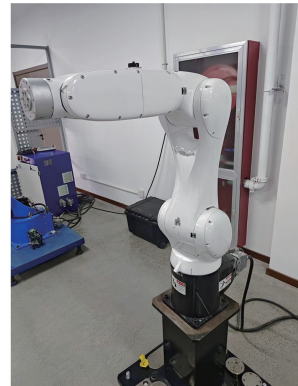
图 1 CCR006-900 型六轴机器人 Fig.1 CCR006-900 6-axis robot
