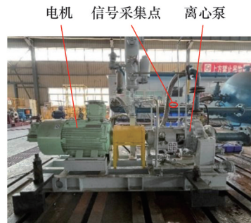
图5 离心泵声信号采集试验台
