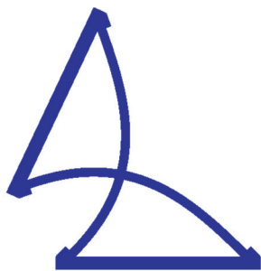
图15 转角1.13 rad时的铰链构型
