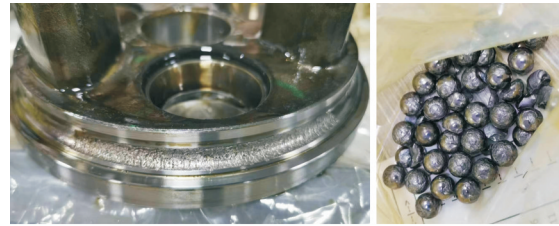
(a)主轴承沟槽失效外观 (b)主轴承钢球失效外观 图13 RV-125N主轴承疲劳失效
