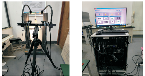
(a) 双目视觉拉伸平台 (b) 全场应变测量系统
